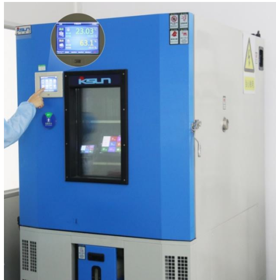
图 4-4 高低温老化测试图
